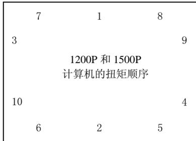
7. 按第 6 步中的顺序以 1.4 Nm (12 lb-in) 扭矩拧紧安装夹，注意不要拧紧过度。
